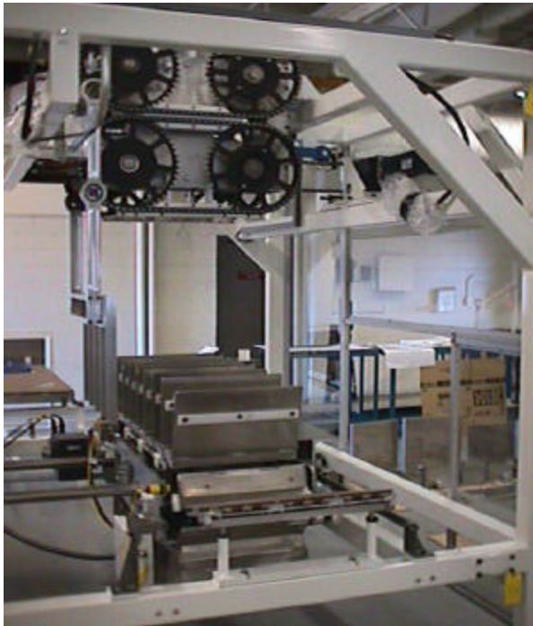
Innenansicht der Produktzuführung, beachten Sie die optionale wegschwenkbare Sammelvorrichtung
